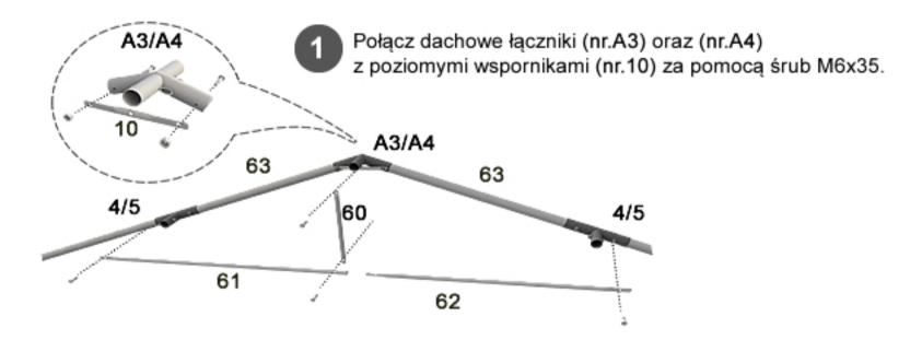
Połącz wsporniki (nr.61) ze wspornikami (nr.62) za pomocą śrub M6x35. Uzyskany element przymocuj do dolnej części łączników (nr.4 lub nr.5)
