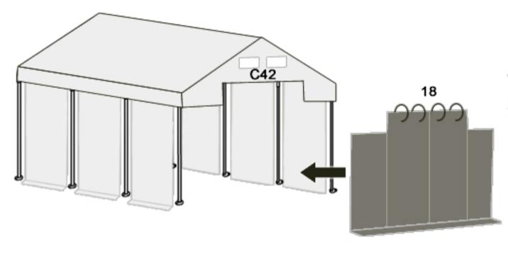
Górną część wjazdu zamontuj za pośrednictwem metalowych oczek (nr.18) do linki poziomej (nr.C42). Natomiast boki wjazdu przymocuj używając gumek z kulką.
